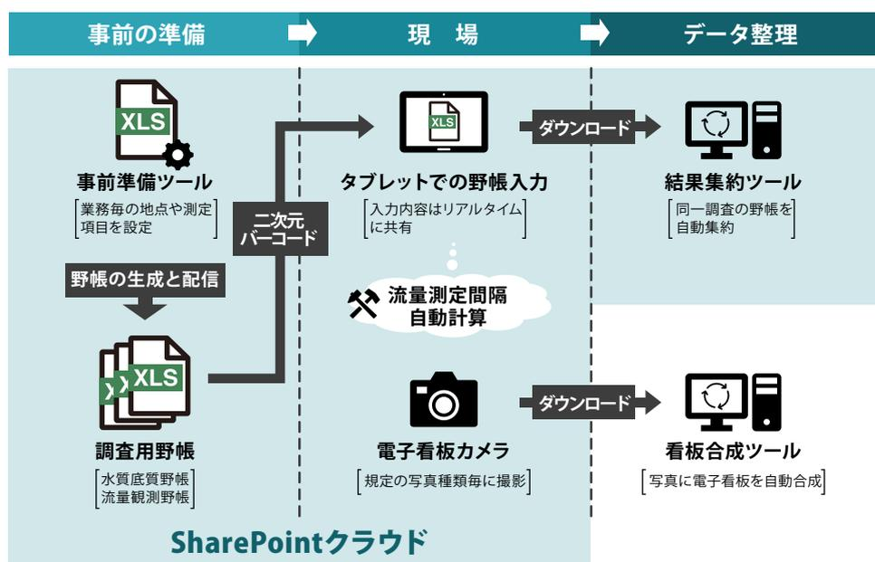
上記のシステムにより、紙野帳から Excel への転記が不要、調査結果と写真の整理の手間が不要となります。また、結果集計ツールによりデータ形式が統一され、調査データのデータベース化コストを抑えることができます。
