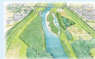
▲ビオトープ再生に配慮した多自然川づくり
