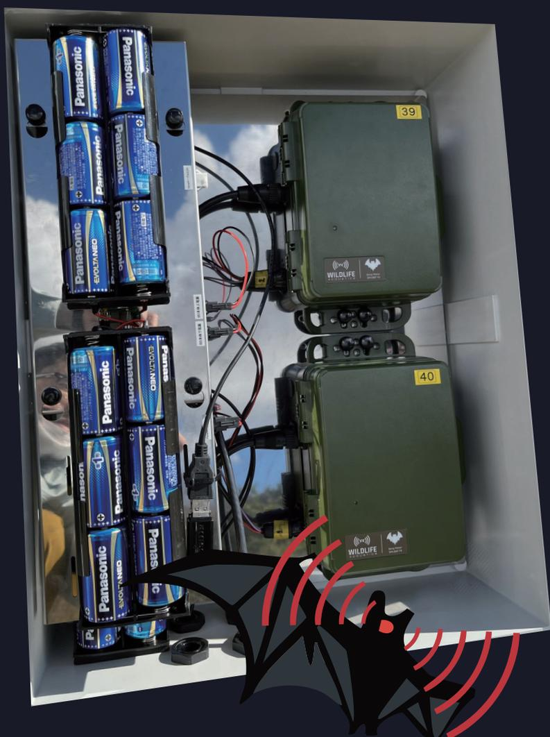
コウモリの生息状況を調査する時に、超音波を録音するバットディテクター（コウモリ探知機）を長期間設置することがありますが、本システムにより電池残量等を遠隔監視し、欠測を防止します。
