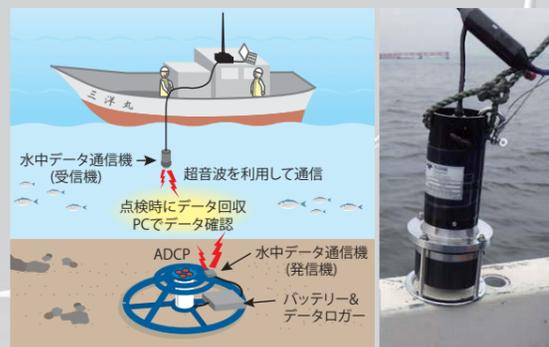
水中音響モデムによるADCPの点検・データ回収
