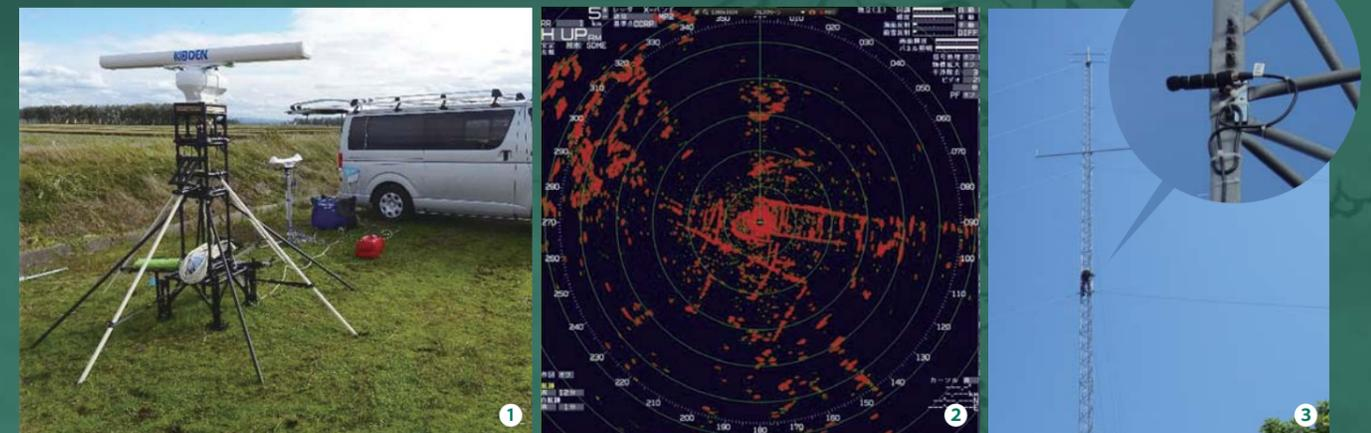
① 船舶レーダー調査風景 ② 船舶レーダーで把握された鳥類飛翔ルート ③ 超音波録音機器設置風景
