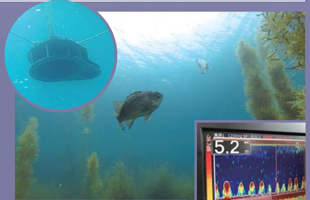
計量魚群探知機による藻場魚類調査の例
